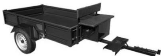
Рисунок А 5 – Тележка для мотоблока ТМ-4/600
